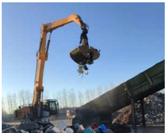
Aufgabe der Elektroaltgeräte auf das Zuführband der MV-ZS-Anlage
